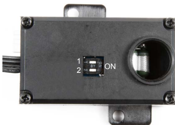
Abbildung 2: Betriebsartenschalter Illustration #2: Mode selector DIP-switches
